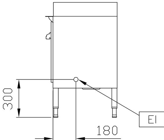
EI = Conexión eléctrica (energía)
